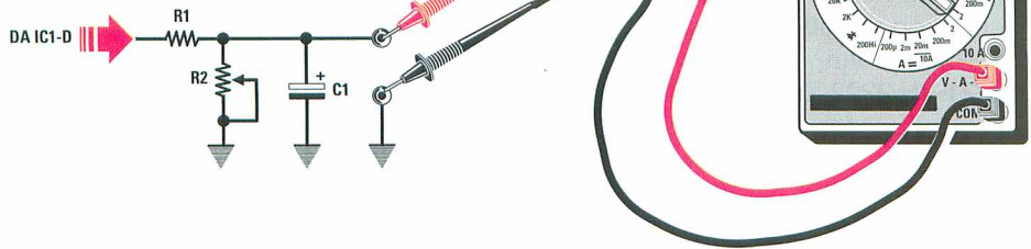
Fig.3 Se collegate il circuito di fig.1 ad un Tester Digitale dovete realizzare questa semplice interfaccia utilizzando un piccolo trimmer da 100.000 ohm (vedi R2).
