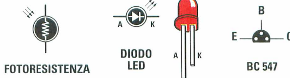
Fig.5 Simbolo elettrico della Fotoresistenza, del diodo Led e del transistor BC.547 viste da sotto. Nel montaggio rispettate la polarità A-K dei due terminali del diodo led.
