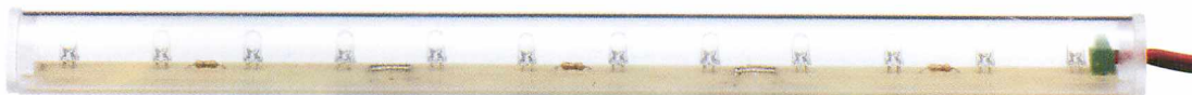
Fig.9 Foto del tubo di plexiglas trasparente al cui interno sono già stati inseriti i tre circuiti stampati LX.1689/B. Per alimentare i led utilizzate una piattina bifilare che collegherete, tramite uno spinotto, alla presa di alimentazione come evidenziato in fig.5.
